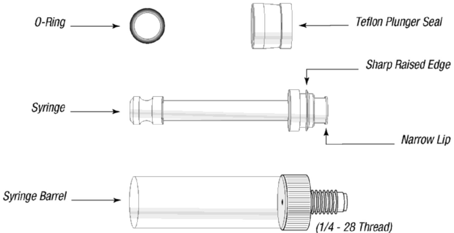
**Figure 1-2. Syringe Components**
